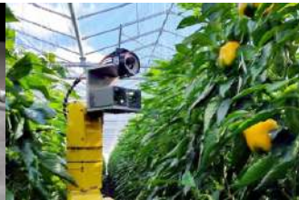
Məhsulun yetişdiyini qiymətləndirən robot
