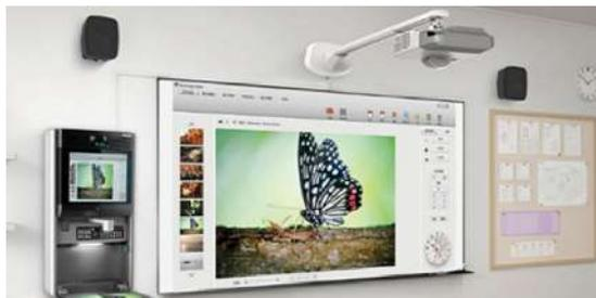
Интерактивная классная доска (e-Доска) - это устройство, состоящее из сенсорного экрана, видеопроектора, компьютера и специального программного обеспечения. На e-Доске можно писать специальной ручкой. Система позволяет выводить на e-Доску любые материалы из e-Библиотеки (учебники, пособия, страницы из тетрадей учеников, видеофильмы, 3D анимации, изображения) и работать
